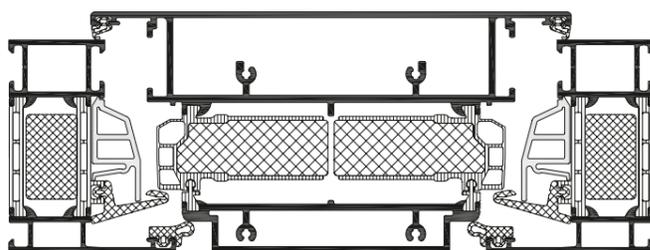
Горизонтальное сечение вентиляционной створки Schüco AWS VV
